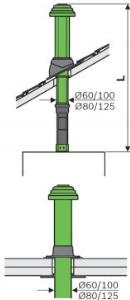
Lunghezze massime ammesse [m] per sistema fumario sdoppiato tipo **C53**, con scarico fumi a parete o su tetto, PP **rigido**
