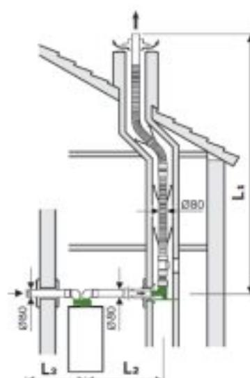
Lunghezze massime ammesse [m] per sistema fumario sdoppiato tipo **C53**, con scarico fumi a parete o su tetto, PP **flessibile**
