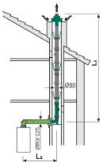
Lunghezze massime ammesse [m] per sistema fumario misto tipo **C93**, con scarico fumi verticale in cavedio, PP **flessibile**
