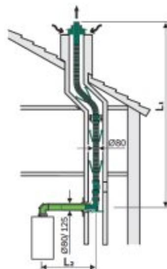
Lunghezze massime ammesse [m] per sistema fumario misto tipo **B23**, con aspirazione aria dal locale e scarico fumi verticale in cavedio, PP **rigido**
